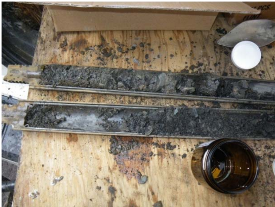
Photo 12 : Sols contaminés retrouvés dans la cuillère fendue au forage manuel F11-8
