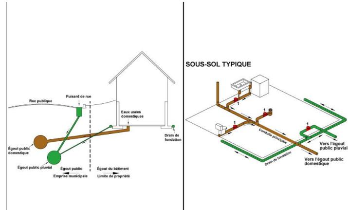
À la fonte des neiges, il y a trop d'eau qui se dirige rapidement dans la même conduite (eau des drains de fondation, eau des toilettes, eau des gouttières, etc.).
